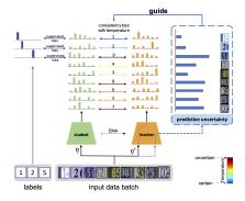
Figure 4: Architektur des CCL mit Temperatur. Das Schüler-Netz wird mit allen Datenpunkte trainiert. Allerdings bestimmt der Rang der Unsicherheit des Datenpunktes wie hoch die Temperatur ist und wie viel das Schüler-Netz aus den gegebenen Trainingsdaten lernen soll [9].
